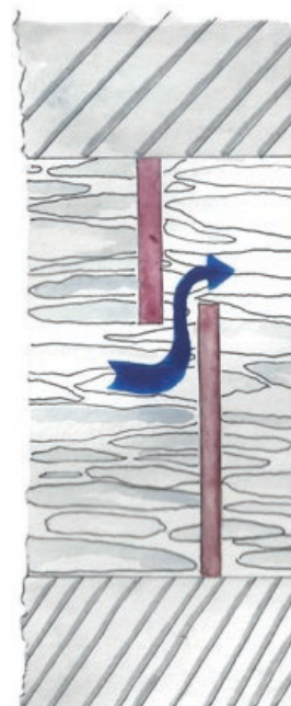
Figure 3: Création d'une chicane à la place d'une fenêtre. © E. Laederach
