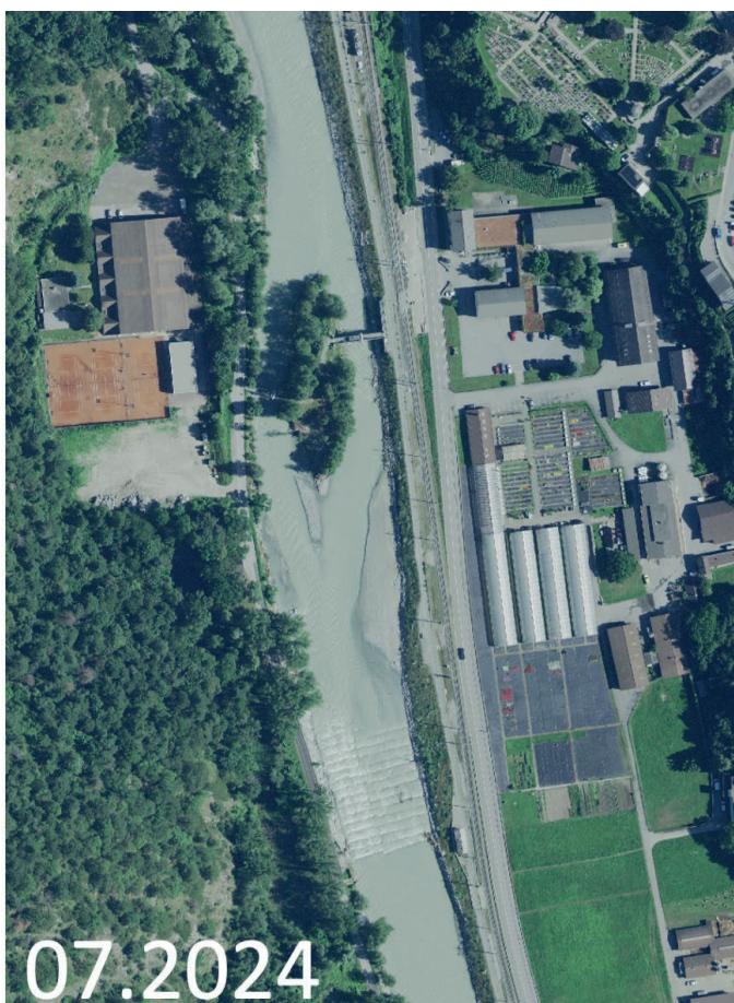
Fig. 5: Vue aérienne (map geo) du seuil (à gauche) et de la rampe à poissons (à droite) de Chatzuhüs. On voit bien les marches d'escalier permettant de diviser la hauteur infranchissable en petites étapes maîtrisables par une truite adulte. (Source: swisstopo)
