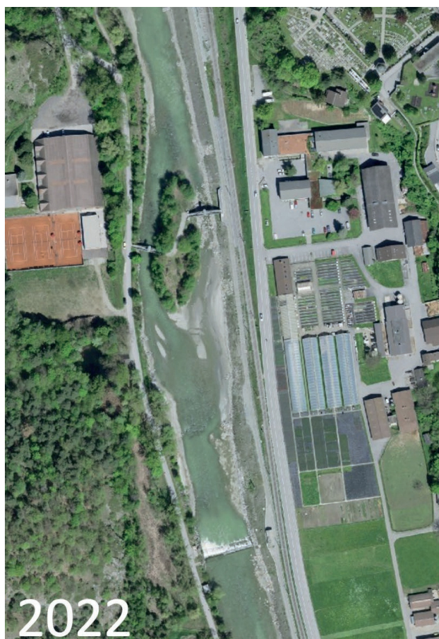
Fig. 5: Vue aérienne (map geo) du seuil (à gauche) et de la rampe à poissons (à droite) de Chatzuhüs. On voit bien les marches d'escalier permettant de diviser la hauteur infranchissable en petites étapes maîtrisables par une truite adulte. (Source: swisstopo)
