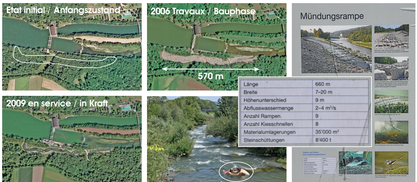
Fig. 2: Un exemple en dehors du Valais: La rivière de contournement de l'usine électrique au fil de l'eau à Auenstein sur l'Aar. Les vues aériennes montrent les différents états. Les baigneurs (cercle) permettent de prendre conscience des dimensions de cette «rampe à poissons». A droite les informations visibles sur place. (Photos aériennes: swisstopo).
