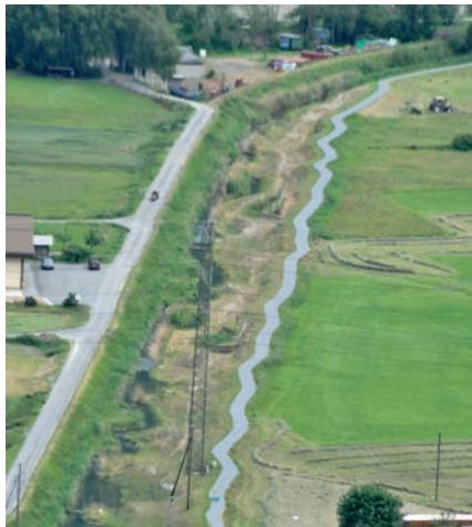
**Fig. 5:** Des méandres figés et sans changement de sections du lit mineur (à gauche) n'apportent guère plus d'améliorations écologiques que les «méandres» du chemin de rive (à droite) (Galdikanal à Gampel)!
