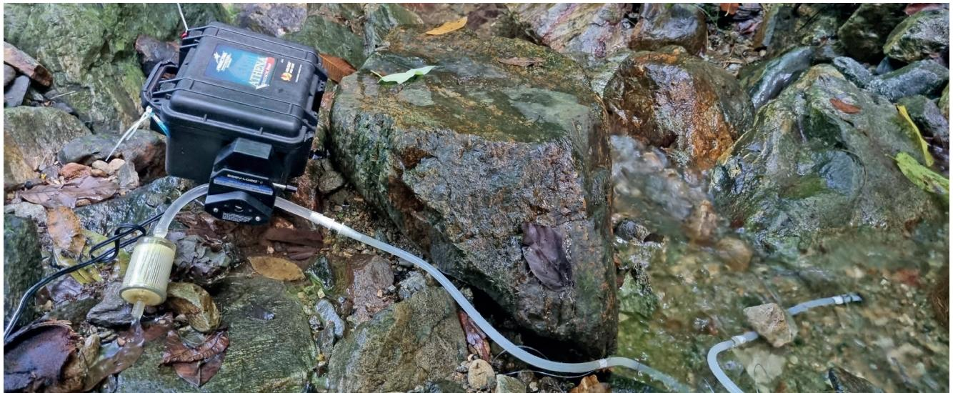
*Echantillonnage d'ADN environnemental avec une pompe péristaltique, un tuyau et une capsule de filtration. La capsule va concentrer l'ADN qui sera analysé en laboratoire.*
